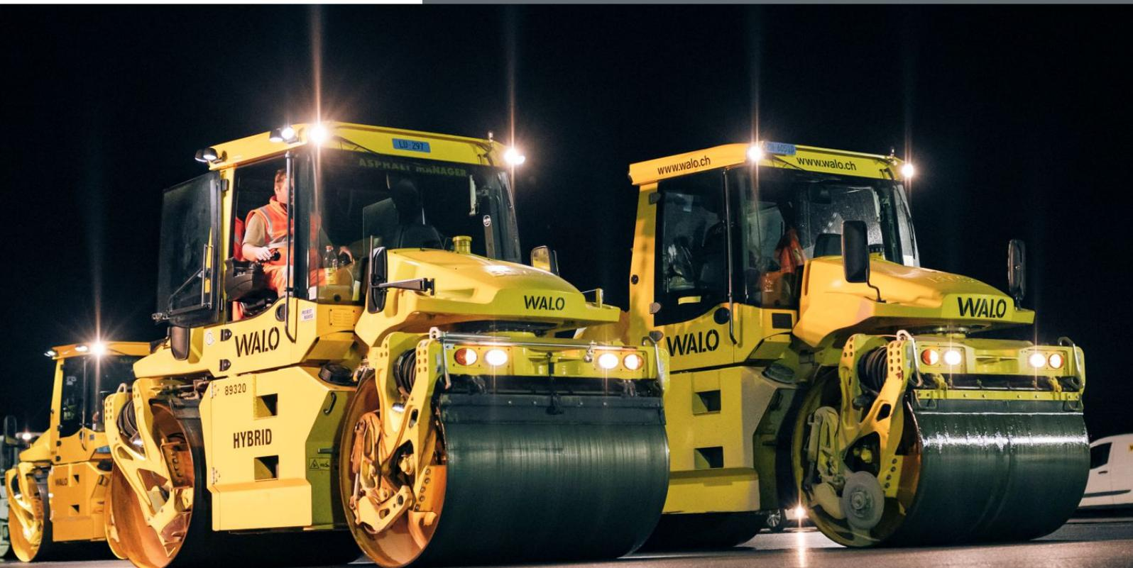
BOMAG BW 174 AP-4 Hybrid mit Asphalt Manager Verdichtungssystem
