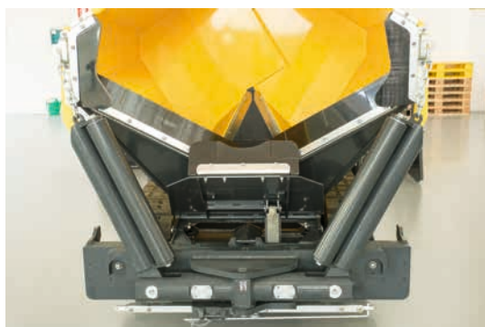
Hydraulische Frontklappe – für sauberen Materialfluss.
