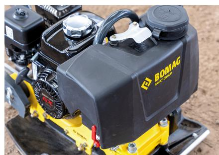
**Système d'arrosage adapté à l'asphaltage**
