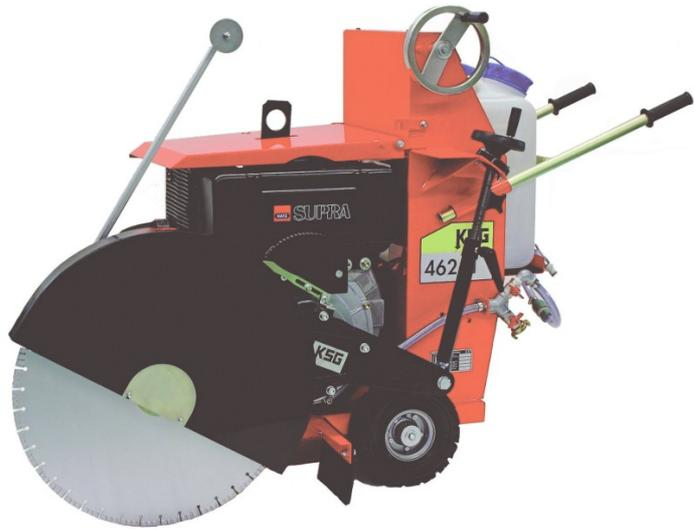
Les grandes roues motrices à profil pour une avance régulière même en cas de support mouillé ou encrassé. L'avance via volant manuel permet de préserver le disque de coupe. Remplacement du disque de coupe sans démontage du carter de protection.
