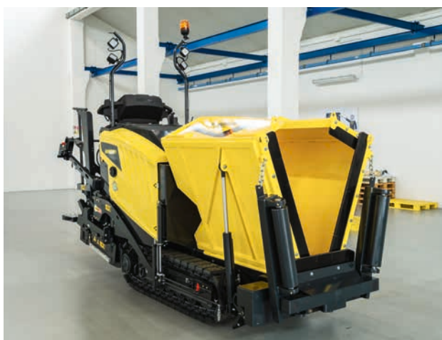
Les trains de chenilles longs assurent une pose parfaitement rectiligne.
