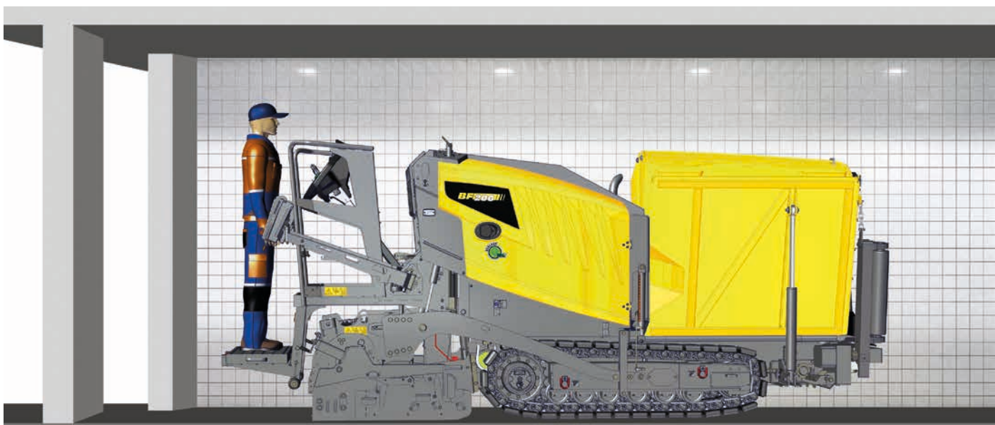
Passe partout – même sous un passage piétonnier souterrain avec une hauteur de seulement 2 mètres.
