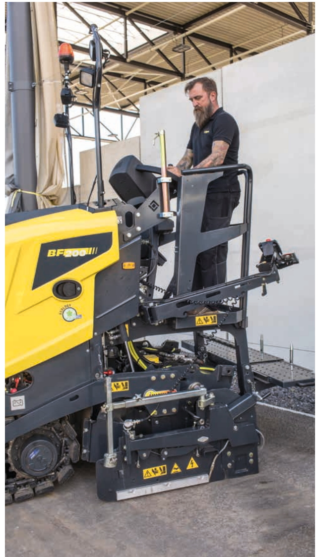
Position haute : vue complète sur la machine.
