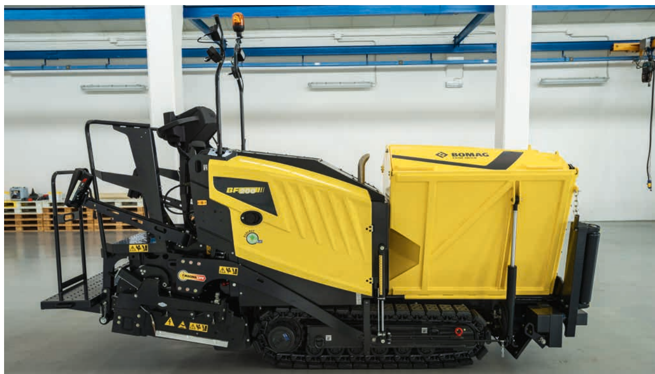
La commande séparée des chenilles permet de manœuvrer dans les espaces les plus étroits.
