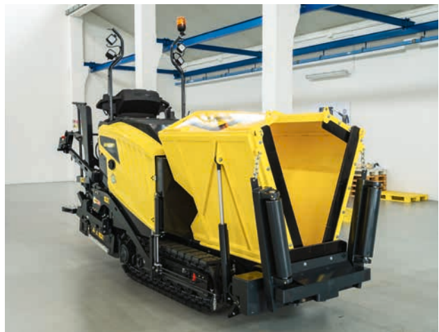
Lange Kettenlaufwerke sorgen für schnurgeraden Einbau.
