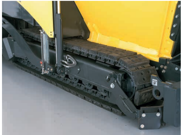
Lange Kettenlaufwerke sorgen für schnurgeraden Einbau.
