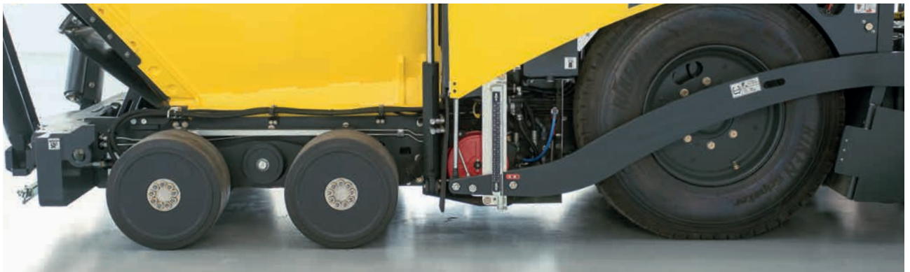
Optionaler 6x6-Radantrieb für maximale Zugkraft.
