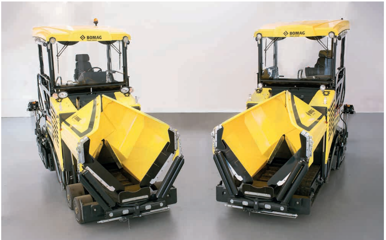
Optionaler 6x6-Radantrieb für maximale Zugkraft.
