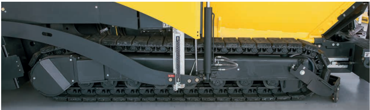
Einzelsteuerung der Kette erlaubt Wenden auf engstem Raum.
