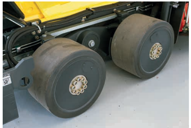
Pendelnd aufgehängte Vorderachse für konstanten Bodenkontakt.
