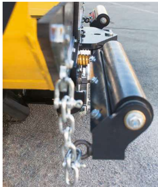
Stoßfreies Andocken – gedämpfter Abdruckbalken.
