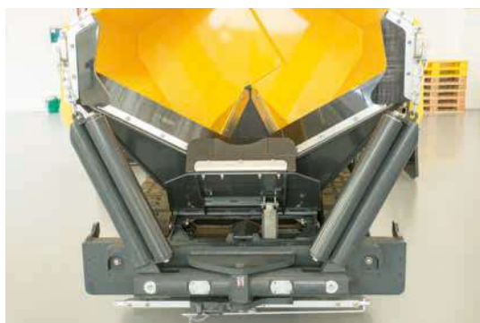
Volet avant hydraulique pour le bon écoulement des matériaux.
