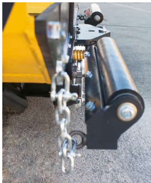
Attache en douceur - rouleaux-pousseurs amortis.
