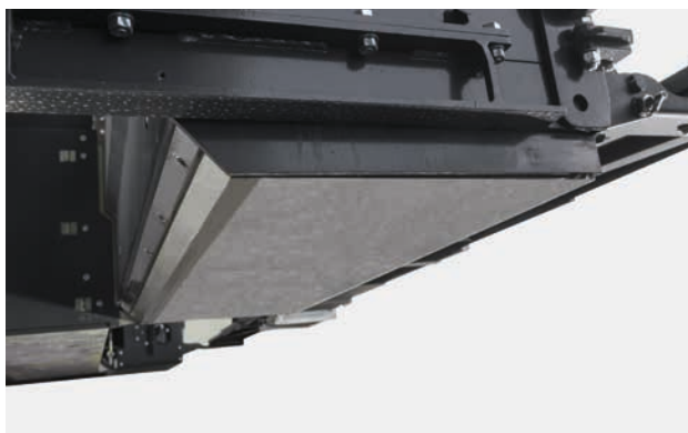
Sehr lange Glättbleche für perfekte Asphalttebenheit.
