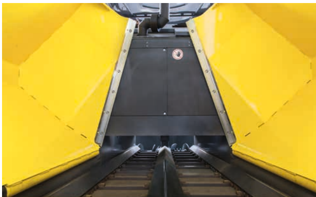
Störungsfreier Materialfluss: das reversierbare Kratzerband.
