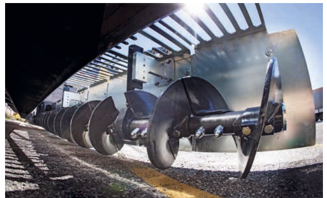
400-mm-Schnecke aus verschleißbeständigem Guss.
