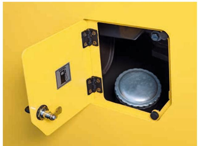
Une fraiseuse étant, en principe chargée par l'arrière, BOMAG a installé son manchon de remplissage sur son côté gauche. Le manchon de remplissage du réservoir se situe du même côté que celui du camion.
