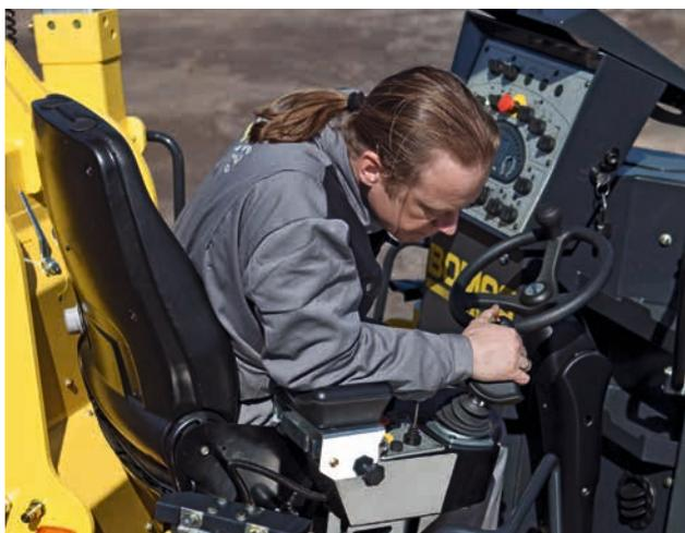
Le siège pivotant sur 45° garantit une excellente visibilité du camion de chargement et du fraisage obtenu.
