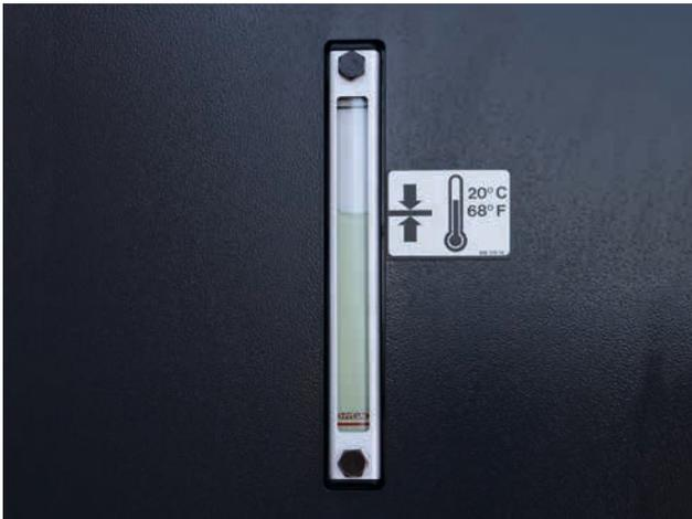
Le conducteur voit immédiatement le niveau de remplissage d'huile hydraulique lorsqu'il monte sur l'escalier menant à la plateforme. Parfaitement visible, l'affichage reste cependant à l'abri des dommages grâce aux contours de la machine.
