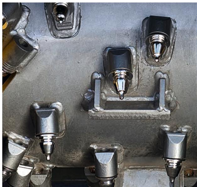
Les pics se démontent vite et facilement par l'arrière augmentant la disponibilité de la fraiseuse et réduisant les arrêts inutiles – du temps et de l'argent gagnés.
