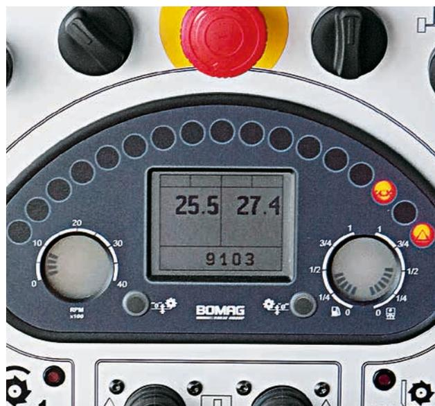
L'affichage numérique de la profondeur de fraisage et les boutons pour les vitesses se trouvent dans le champ de vision du conducteur.
