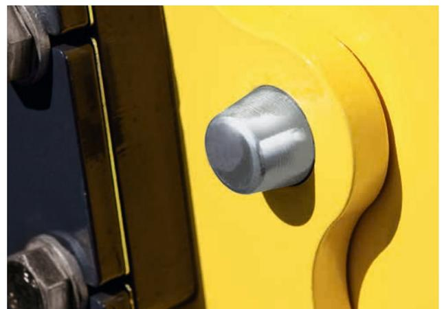
Der Zentrierdorn schützt die Gewinde der Fräskastentür.
