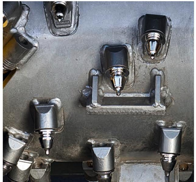
Die Meißel selber lassen sich schnell und einfach von hinten austreiben. Das sorgt für eine hohe Verfügbarkeit der Fräse und reduziert unnötige Standzeiten – mehr Zeit zum Geldverdienen.
