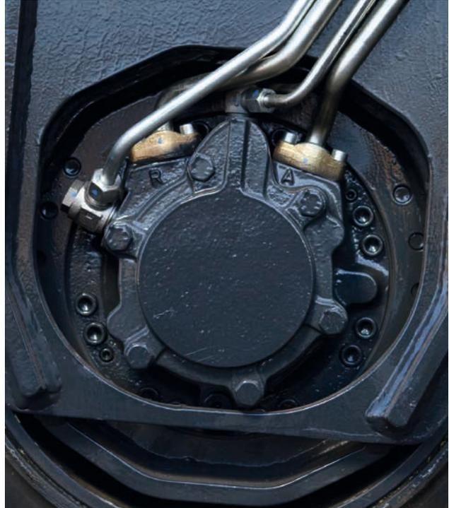
Schlanke Verlegung der Hydraulikleitungen in der Radkastenkontur.
