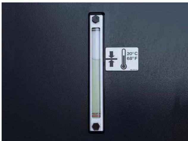
Der Hydrauliköl-Füllstand befindet sich direkt im Sichtfeld des Fahrers, wenn er über die Treppe auf die Bedienerplattform steigt. Gut sichtbar ist die Anzeige dabei aber von der Maschinenkontur vor Beschädigungen geschützt.
