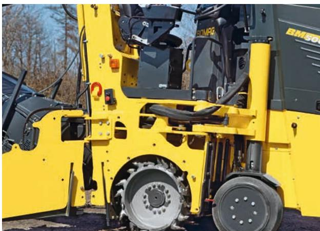
... und schon ist der Zugang zur Fräswalze frei.
