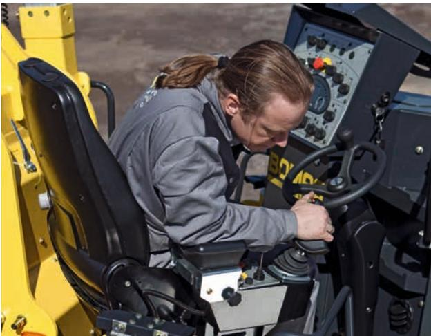
Der um 45 Grad schwenkbare Sitz ermöglicht beste Sicht auf den Lade-Lkw und die Fräskante.
