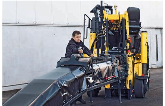
Sicheres, einfaches Einhängen der Kette – nur mit einer Hand!
