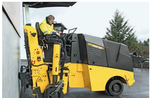
Kein störender Verstellzylinder im Heckbereich der Fräse.
