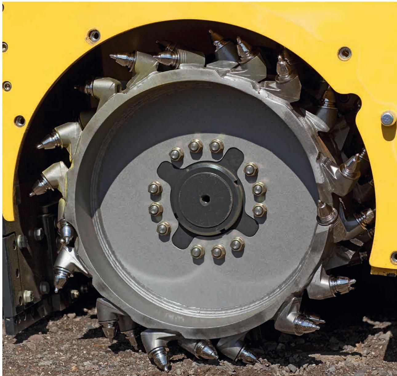
Die spezielle Geometrie der Randmeißel erzeugt eine glatte Schnittkante mit minimierten Ausbrüchen. Dadurch reduzieren sich die Nebenarbeiten und somit auch die Kosten für den Bauunternehmer. Neue Seitenschnei-
