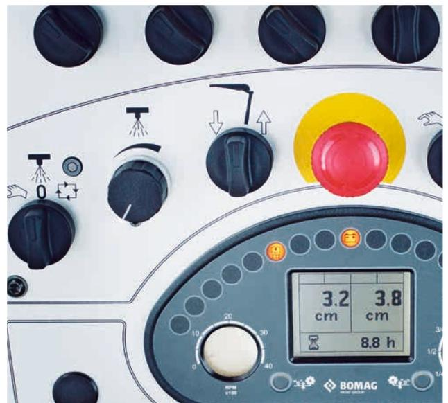
Einfache Regelung der Wassereinsprühung über zwei Bedienschalter.
