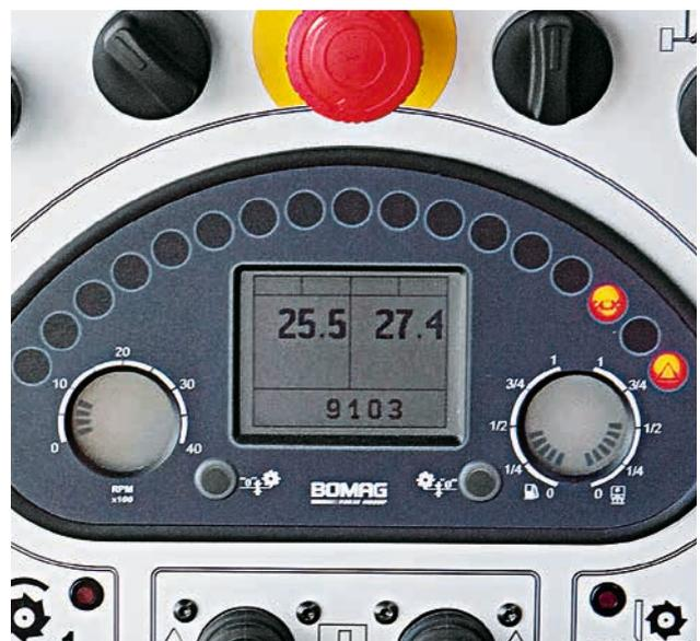
Die digitale Frästiefenanzeige und die Schalter für die Verfahrgeschwindigkeiten liegen genau im Blickfeld des Bedieners.
