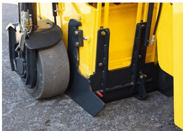
Gleitkufen aus Hartmetall – die halten einiges aus.
