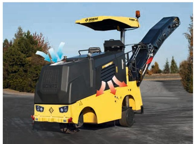
Schallisolierung und intelligente Luftführung.
