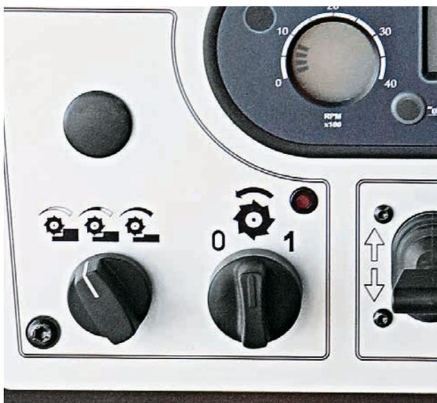
Manuell einstellbar – die beste Schnittgeschwindigkeit für jede Anwendung.
