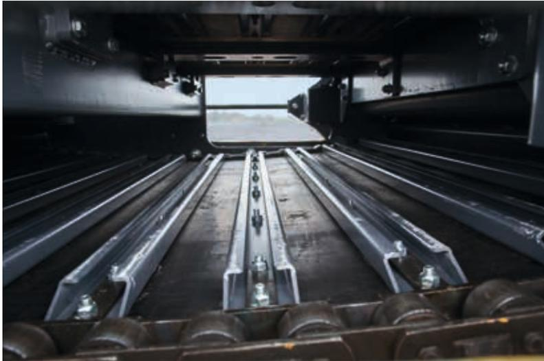
Zuverlässig: das kettenverstärkte Förderband.
