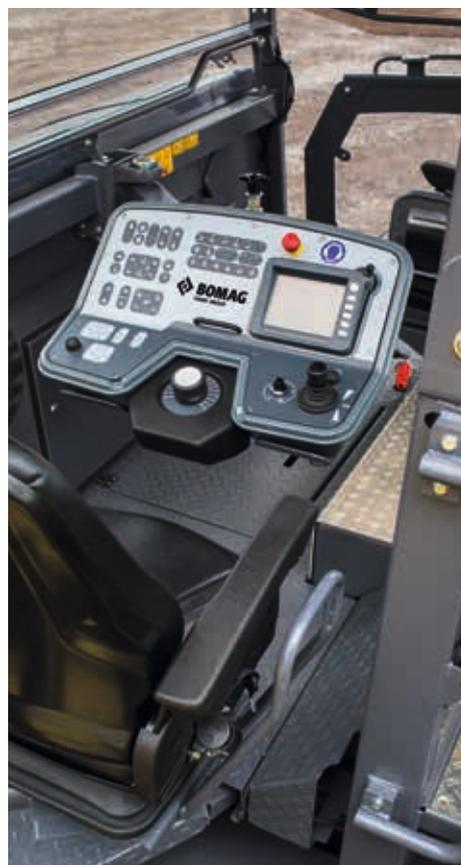
Komfortabel: drehbarer Sitz mit Bedienpanel.
