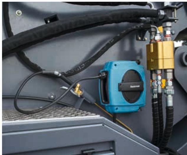
Für bequeme Reinigung: der Schlauchwickler mit Kupplungen.
