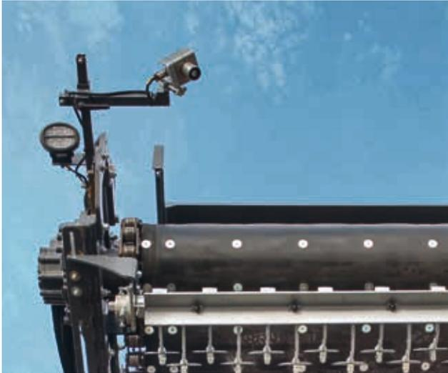
Automatisierter Materialfluss: der Füllstandssensor.
