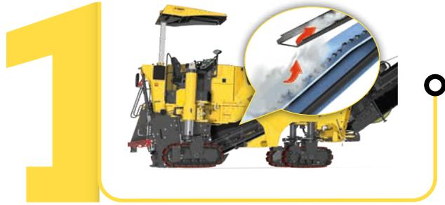
Les poussières sont d'abord aspirées à l'endroit où elles sont produites (au niveau de la zone de transition entre le carter de fraisage et le convoyeur).
