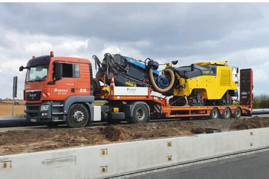
Même mesuré en kilogrammes : le poids de base de la nouvelle BM 1000/35-2 s'est allégé de 1,5 t par rapport au modèle précédent. Cette fraiseuse sur chenilles d'une puissance de 350 ch est ainsi la plus légère de sa catégorie. Avec un poids de transport inférieur à 20 t, elle répond à cet égard aux normes les plus rigoureuses.
