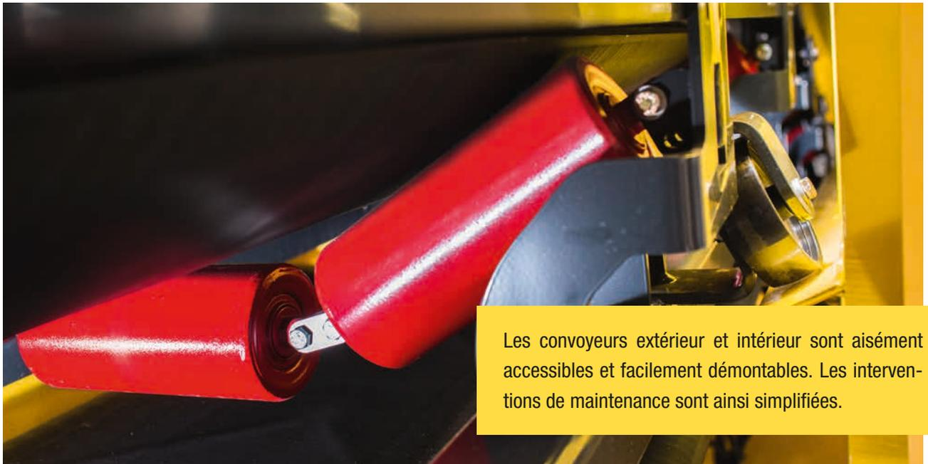
Les convoyeurs extérieur et intérieur sont aisément accessibles et facilement démontables. Les interventions de maintenance sont ainsi simplifiées.
