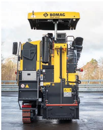
Toit en position standard, siège pivoté vers l'extérieur.
