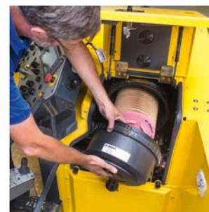
Le remplacement manuel du filtre à air s'effectue tout aussi facilement et rapidement.
