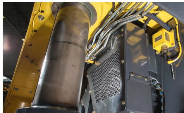
Le train à chenilles et les colonnes de levage présentent une solidité supérieure à la moyenne. Le large diamètre des colonnes réduit la pression sur la surface et augmente la longévité des guides.
