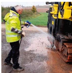
Nettoyage facile de l'engin après le fraisage avec l'enrouleur de tuyau en option.
