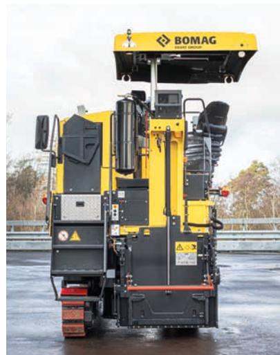
Toit déployé au-dessus du siège pivotant.
