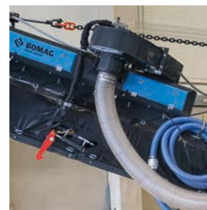
ION DUST SHIELD de BOMAG : sans filtre, se nettoie facilement à l'eau.
