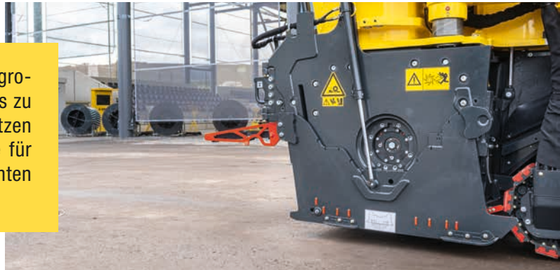
Auswechselbarer Hartmetall-Verschleißschutz des Fräskastens und der Fräsrolle.
