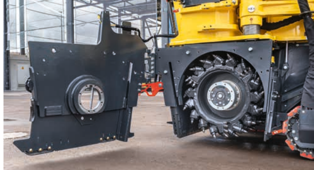
Auswechselbarer Hartmetall-Verschleißschutz des Fräskastens und der Fräsrolle.
