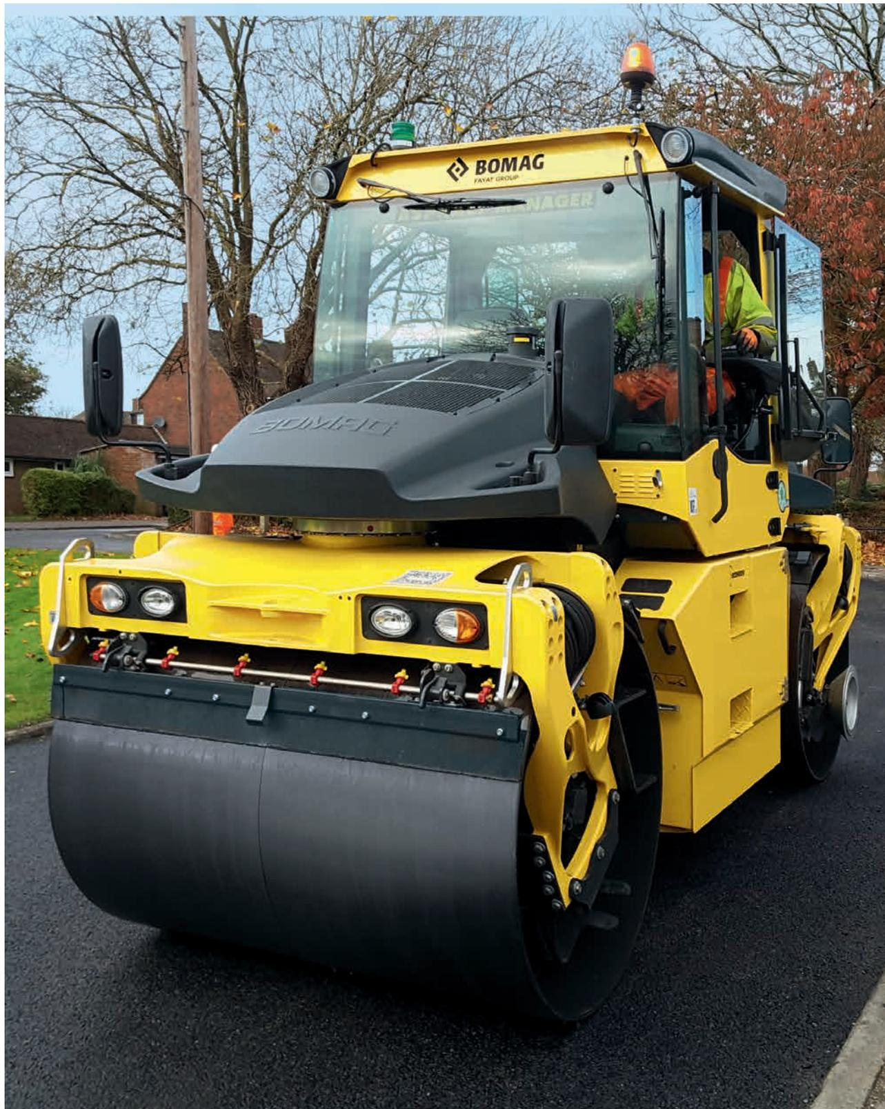
Avec le nouveau BW 174 AP hybride, BOMAG rend possible l'impossible : associer efficacité et écologie. Ce nouveau rouleau tandem innovant réunit dans une même unité motrice ultra-efficace un accumulateur hydraulique novateur, un moteur diesel et l'ASPHALT MANAGER. Une combinaison qui a un effet bénéfique tant sur les coûts de fonctionnement que sur l'environnement.
