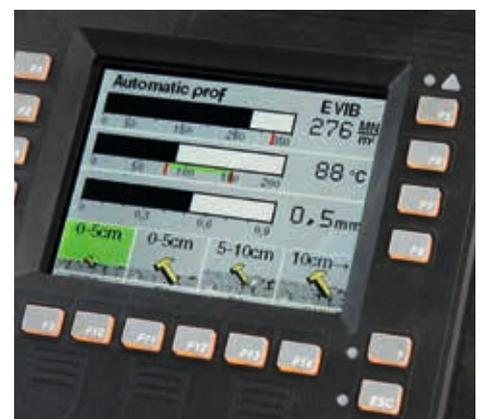
Übersichtliches Display: Stets alle Werte sicher im Blick. Schichtdicken-Vorwahl per Tastendruck.
