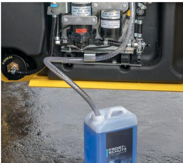
Antigel pour les buses et le tuyau d'arrosage : ouvrez simplement le bouchon à vis, l'eau résiduelle s'écoule, puis le tuyau et les buses d'arrosage sont automatiquement rincés avec de l'antigel.
