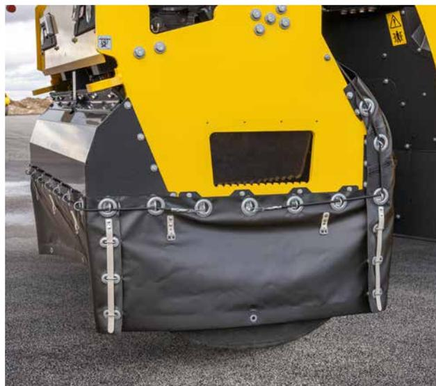
Les jupes thermiques empêchent le refroidissement des pneus lors du compactage avec des rouleaux tandems mixtes.
