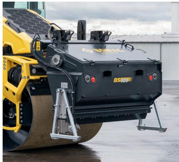
Les gravillonneurs de précision BS 150 et BS 180 conviennent parfaitement à tous les matériaux d'épandage courants, tels que des gravillons d'une granulométrie de 2/5 et 1/3, ou du sable concassé d'une granulométrie de 0/2.
