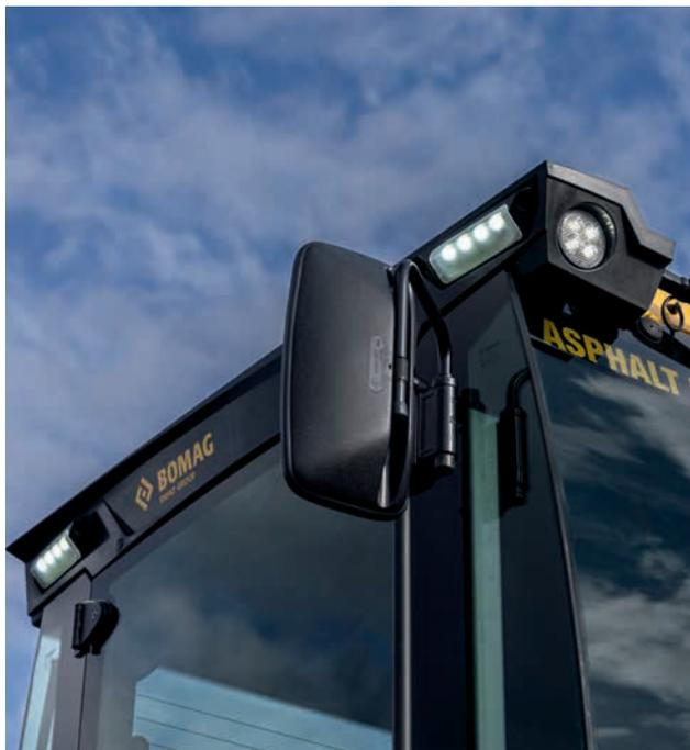
Fonction Follow me Home : les engins qui sont équipés du pack « Éclairage » en option disposent en complément de la fonction Follow me Home. Les deux phares situés sur le côté de la cabine restent allumés un certain temps après l'arrêt de l'engin pour permettre au conducteur de mieux se déplacer sur le chantier.
