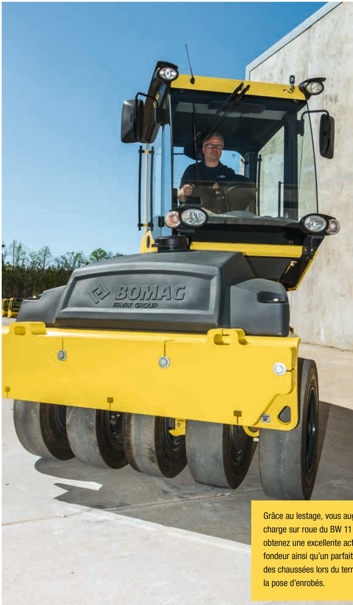
Grâce au lestage, vous augmentez la charge sur roue du BW 11 RH-5, et obtenez une excellente action en profondeur ainsi qu'un parfait scellement des chaussées lors du terrassement et la pose d'enrobés.
