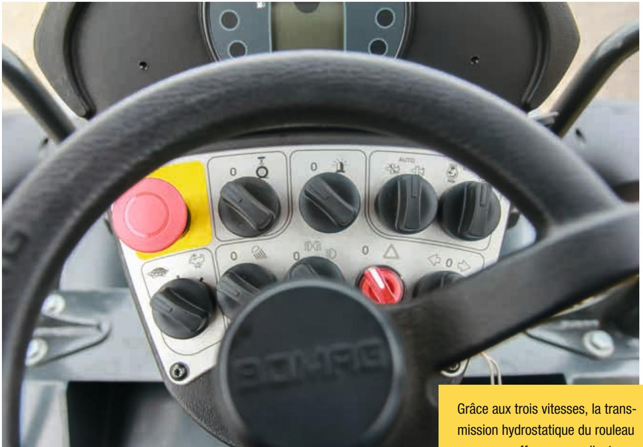
Grâce aux trois vitesses, la transmission hydrostatique du rouleau sur pneus offre une excellente aptitude en pente et une vitesse maximale.
