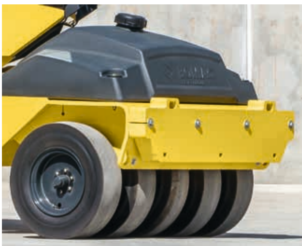
Um die Kippstabilität zu erhöhen, wurden die Ballasträume, wie hier über der Vorderachse, sehr tief gelegt.
