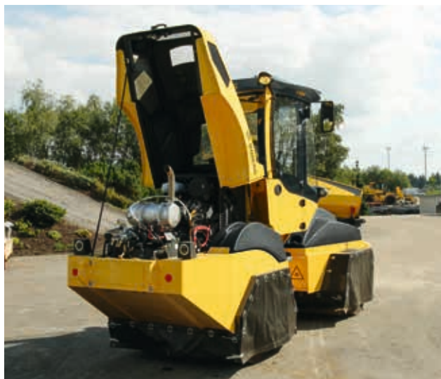
Die weit aufklappbare Motorhaube ermöglicht einen raschen und ungehinderten Zugang zum Motor.
