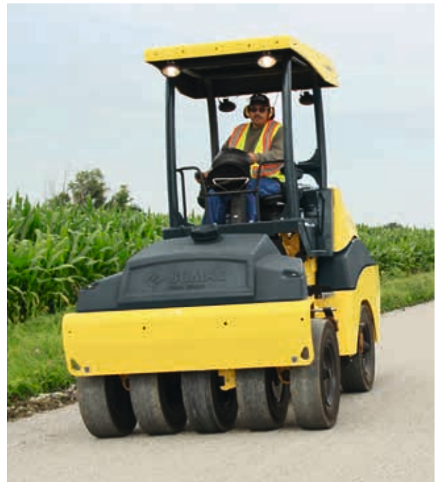
Mit der BW 11 RH-5 erreichen Sie eine optimale Verdichtung und ein besonders ebenmäßiges Oberflächenbild.
