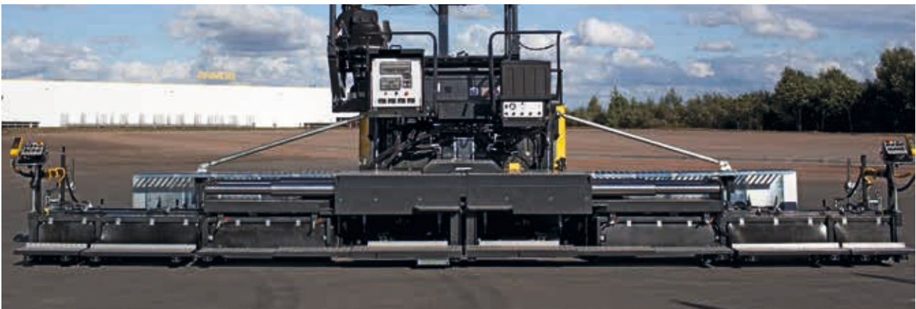
BOMAG Hochleistungsbohle S 600 auf 10,0 m angebaut.
