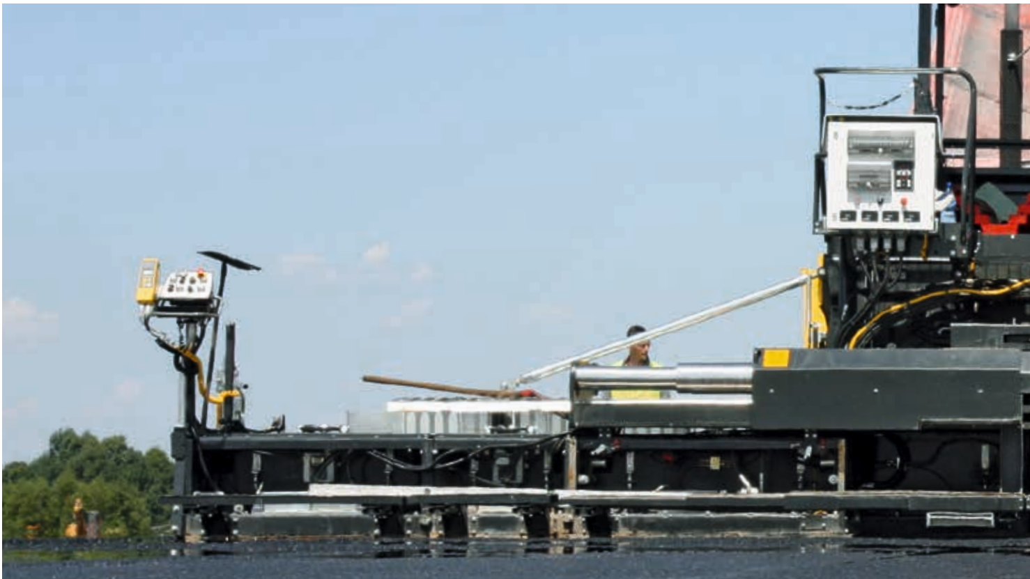
Bis zu 40 cm tiefe Glättbleche für eine perfekte Ebenheit.
