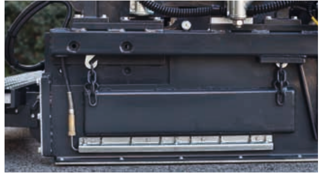
Die Seitenblechheizung wird unabhängig von der Bohlenheizung betrieben und schützt somit die kritischen Randbereiche vor Auskühlung.
