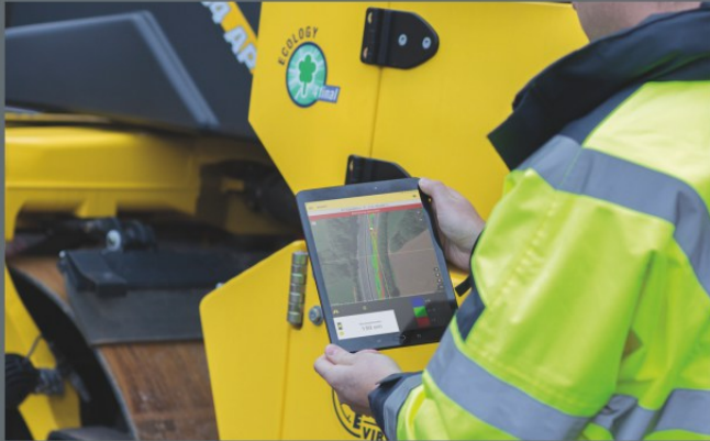
Bomag zeichnet die Verdichtungsergebnisse flächendeckend auf und speichert sie automatisch ab
