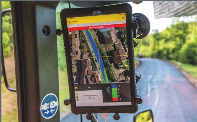
Mit Antenne zeigt Bomag den Standort der Walze in Echtzeit und mit einer sehr hohen Genauigkeit an
