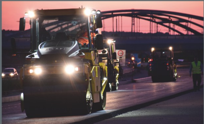
Dank Partikelfilter, Oxikat und gekühlter Abgasrückführung kommt die Maschine ohne AdBlue aus
