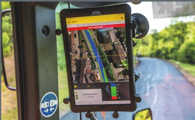
Avec antenne, l'app Bomap indique la position du rouleau en temps réel avec une haute précision
