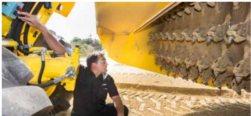
Einfache Kontrolle des Rotors mit Sicherheitsabstand zwischen Bedieneinheit und Rotor.
