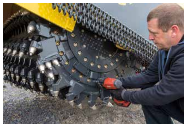
Wechsel der Randsegmente ohne Ausbau des Rotors.
