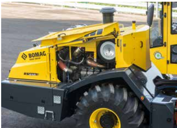
Alle Wartungspunkte gut zu erreichen: Wasserfilter, AdBlue, Zentralschmieranlage.
