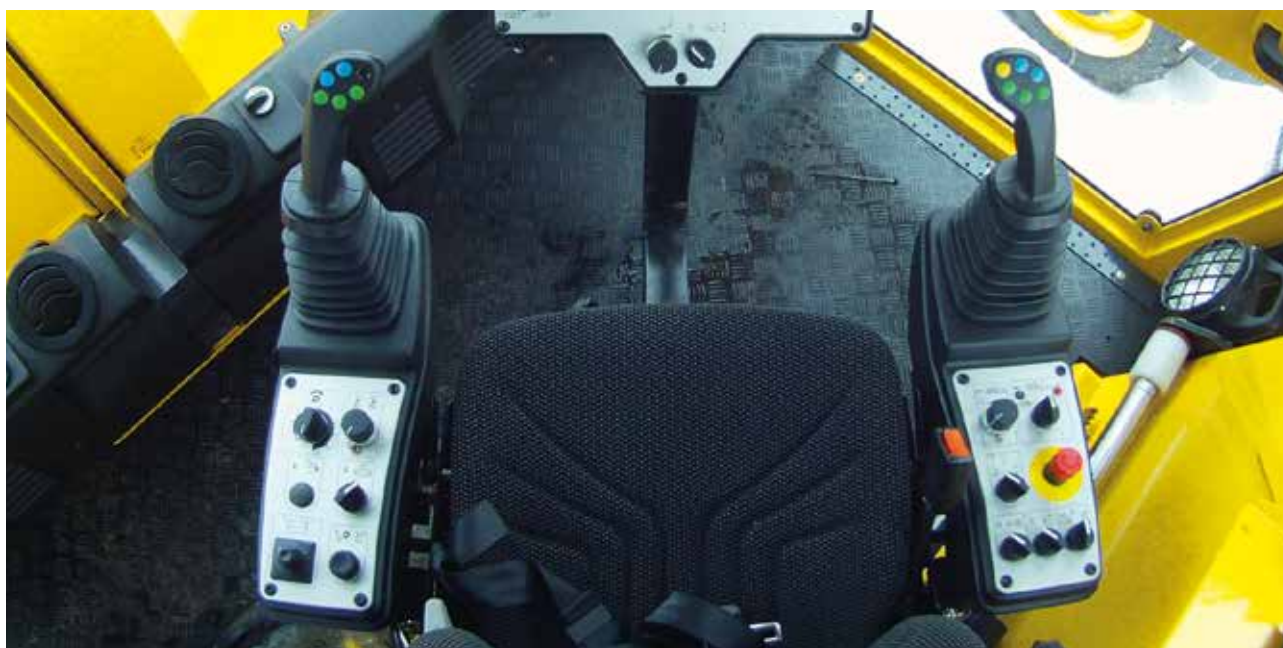
Zwei Joysticks in den Armlehnen für leichtes Handling der Maschine.
