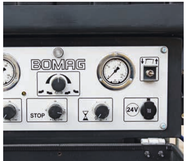
Contrôle automatique garantissant une parfaite planéité. Système Load-Control (L.C.S.) de BOMAG.
