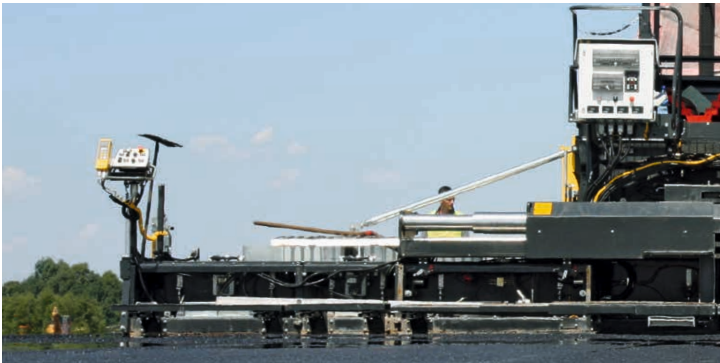
Des tôles lisseuses atteignant 40 cm de profondeur pour une planéité parfaite.
