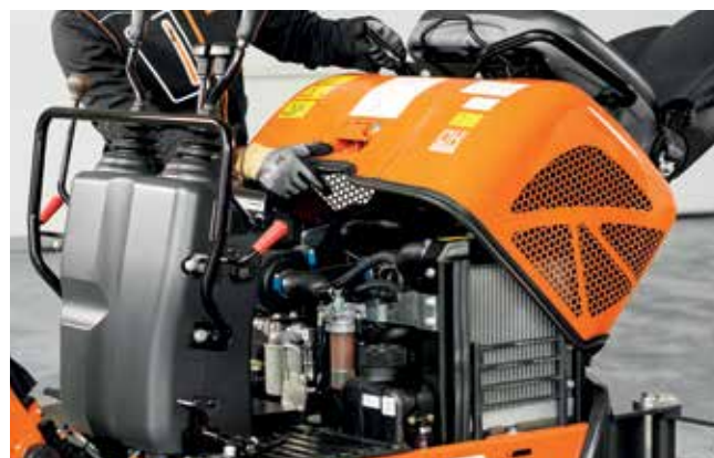
Les capots à grande ouverture facilitent l'entretien.
