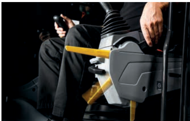
Le levier d'arrêt du pilote accroît la sécurité de la cabine.
