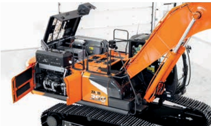
Die Motorabdeckung mit Dämpfern (ZX300/ZX350) ermöglicht einen leichten Zugang für tägliche Inspektionen.
