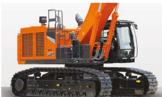
Une nouvelle marche permet de faciliter l'accès à la structure supérieure.
