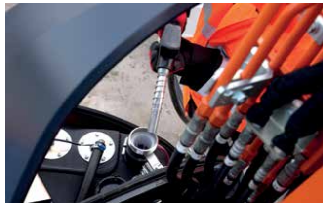
Der Kraftstofftank wurde ebenfalls neu positioniert, um das Nachfüllen einfacher und sicherer zu machen.
